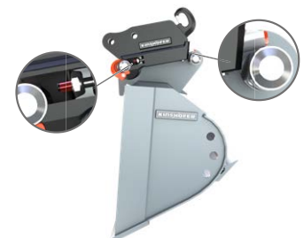
Verrouillage non correct. Les axes de verrouillage sont au-delà de la plage permise. L'axe indicateur est sorti.
